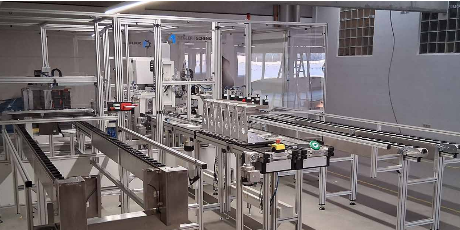
Teilautomatisierte Montagezelle für Bewehrungstechnik
